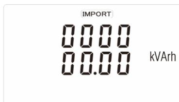
Hier wird die aufgenommene Blindleistung [kVArh] phasenbezogen angezeigt.
