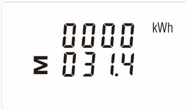
Hier wird die Gesamt-Wirkleistung [kWh] angezeigt.(0000 031,4kWh
