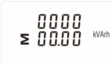
Hier wird die Gesamt-Blindleistung [kVArh] angezeigt.
