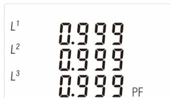
Hier wird der Leistungsfaktor für alle Phasen angezeigt.
