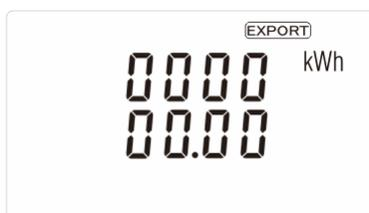
Hier wird die abgegebene Wirkleistung [kWh] phasenbezogen angezeigt.
