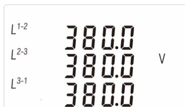
Hier werden die aktuellen Spannungen [V] zwischen den Phasen und dem Neutralleiter (3p3w) angezeigt.
