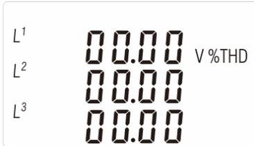
Hier wird die harmonische Spannungsverzerrung zwischen den Phasen und dem Neutralleiter [%] angezeigt.
