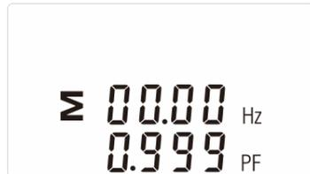
Hier werden der Gesamtwert der Frequenz [Hz] und der Leistungsfaktor [PF] angezeigt.
