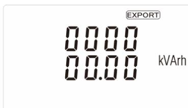
Hier wird die abgegebene Blindleistung [kVArh] phasenbezogen angezeigt.
